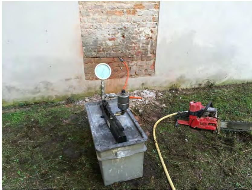
**Figura 7.20:** Fase di applicazione del carico alla muratura
