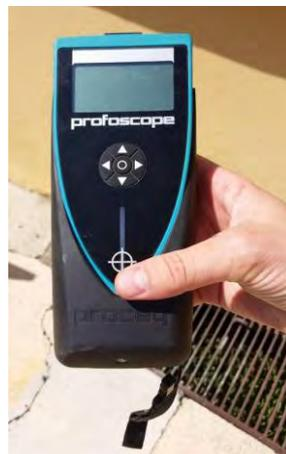
**Figura 8.17:** il pacometro Profoscope + utilizzato nelle indagini
