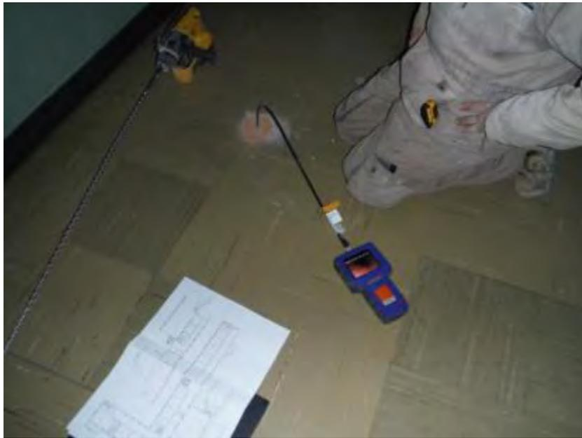
**Figura 7.1:** Particolare dell'esecuzione di un'endoscopia del solaio (piano terra)
