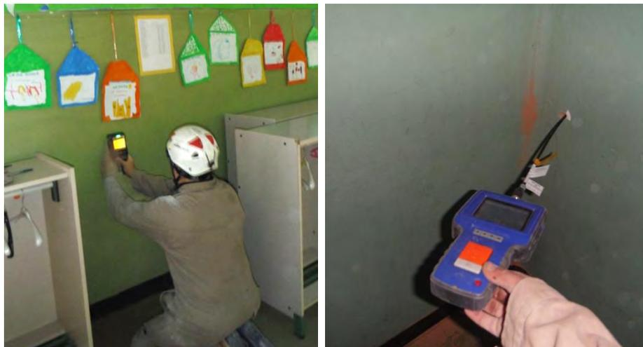
**Figura 7.13:** Particolare dell'esecuzione di un endoscopia del muro portante (piano terra)
