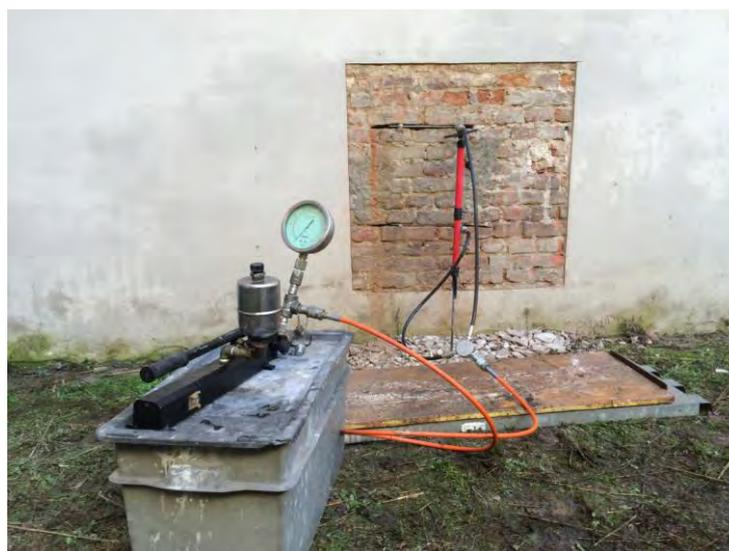
**Figura 7.23:** Fase di applicazione del carico a entrambi i martinetti
