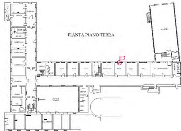
**Punto di rilievo:** Piano terra – muro esterno (lato via Torti): Altezza foro da terra = 110 cm; distanza foro da lato destro del muro = 45cm.
