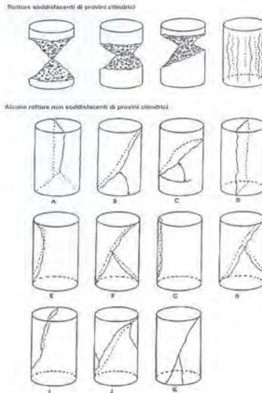
**Figura 8.23:** possibili tipologie di rottura delle carote
