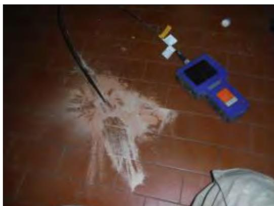
**Figura 7.4:** Particolare dell'esecuzione di un'endoscopia del solaio (piano primo)
