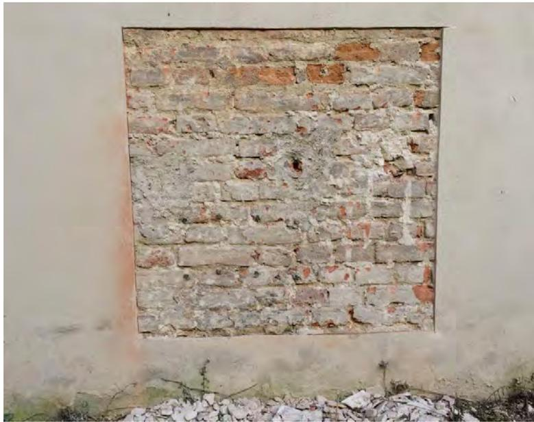
**Figura 7.18:** Porzione di muro oggetto di prova con martinetto piatto
