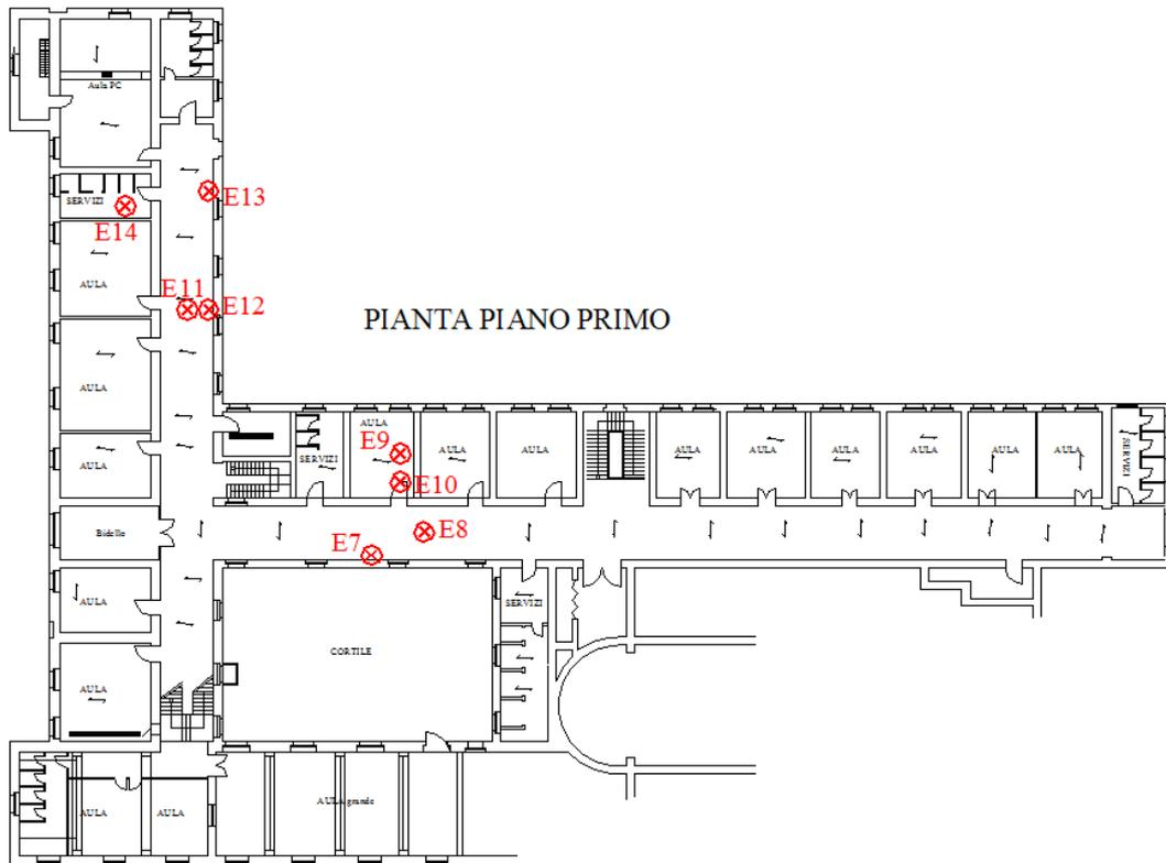
**Figura 7.5:** Posizione delle Endoscopie sul pavimento del piano primo della scuola
