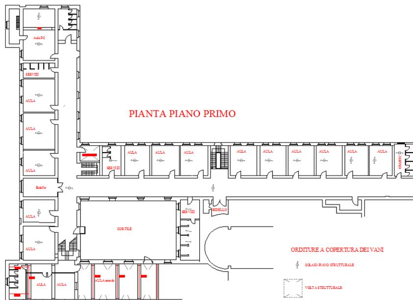
**Figura 5.18:** Rilievo del primo piano aggiornato e corretto (ALLEGATO 5)
