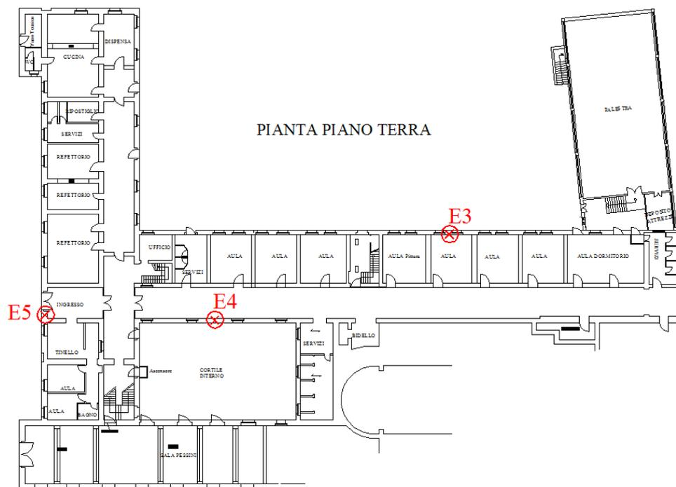
**Figura 7.14:** Posizione delle endoscopie sui muri del piano terra della scuola
